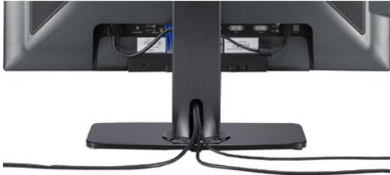
在连接好所有需要的显示器和计算机线缆后，（请参阅[连接显示器](#)了解如何排线），请使用线缆固定座整理所有线缆。
